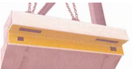
Trittschalllagerung der vorgefertigten Treppe
