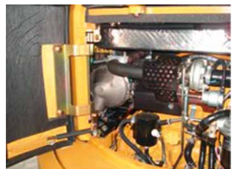
Eingebauter Partikelfilter in einer neuen Baumaschine
