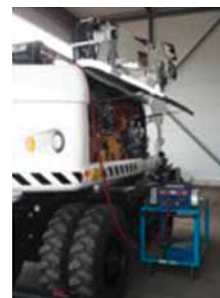
Emissionsmessung eines Partikelfiltersystems
