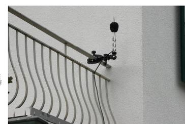
*Messgrafik Lärmmessung und Messgerät (Mikrofon)*
