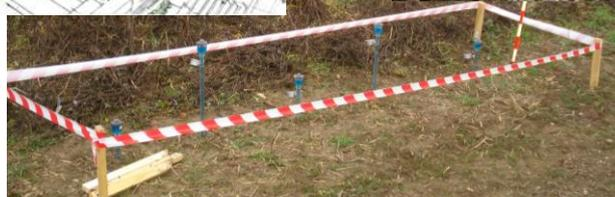
Tensiometerstation zur Messung der Bodenfeuchtigkeit
