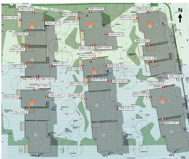
Plan mit Lärmquellen (Orange) und Beurteilungspunkten (Rot); Schnitt mit Immissionen, ohne Massnahmen.
