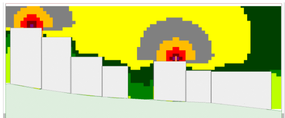
Plan mit Lärmquellen (Orange) und Beurteilungspunkten (Rot); Schnitt mit Immissionen, ohne Massnahmen.
